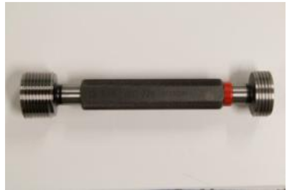
Afb. 5 Goedkeur / Afkeur draadkaliber
