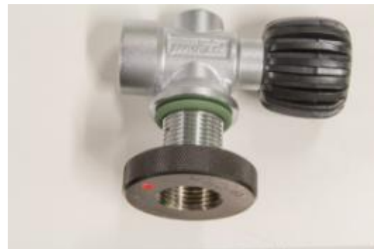
Afb. 9 Ringkaliber loopt vast, draad binnen tolerantie
