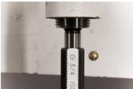
Afb. 6 Kaliber past volledig in de cilinder
