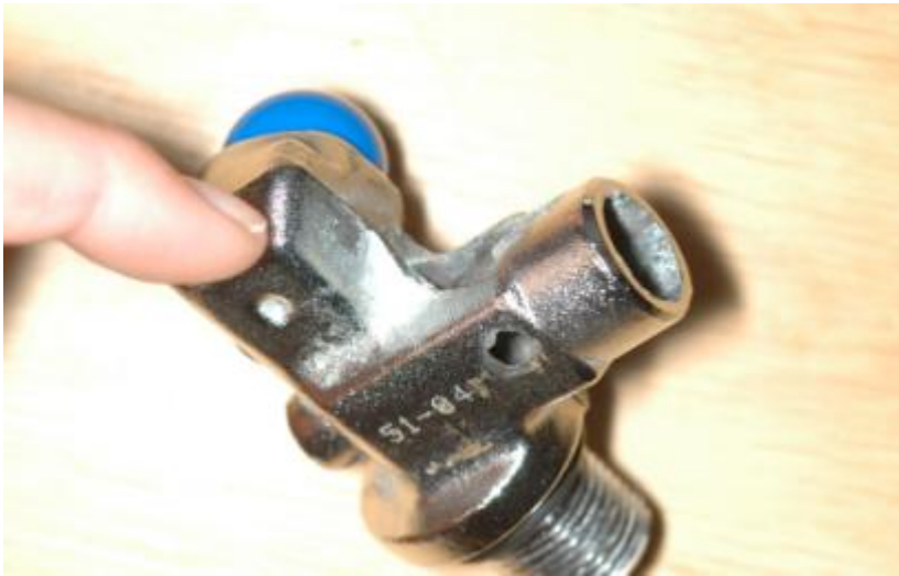
Afb. 13 Uitgebrande kraan door zuurstofbrand
