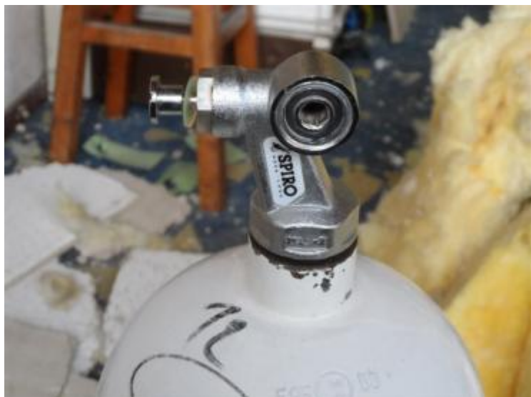
Figuur 2 De fles met 3/4" draad en M25x2 kraan
