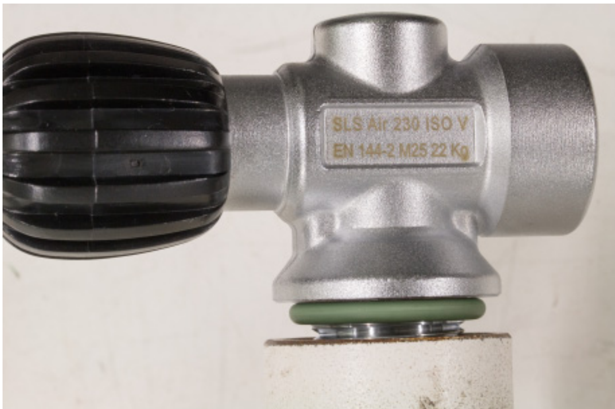
Afb. 4 Levensgevaar, een M25x2 kraan in een G 3/4"fles gaat er bijna helemaal in....
