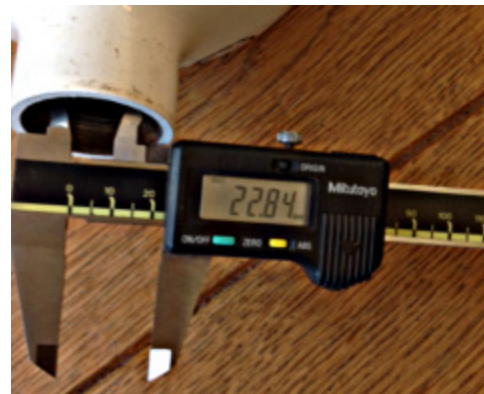
Afb. 1 De inwendige maat van een M25x2 cilinder
