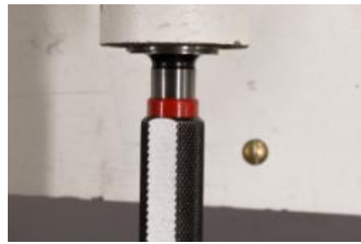
Afb. 7 Kaliber loopt vast, draad is binnen tolerantie
